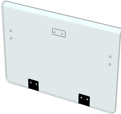
Hammerglass-Scheibe IR Green zum Tausch gegen Originalscheibe. Mit werksseitig montierter ScreenSaver Schutzfolie. Hammerglass IR absorbiert die IR-Strahlung der Sonne und verringert die Erwärmung um 50%. Wird verklebt wie Originalscheibe. **ACHTUNG!** Verwenden Sie einen elastischen Kleber. NICHT den Standard Glaskleber verwenden. Folie kann ersetzt werden bei Kratzer, oder Beschädigungen.
