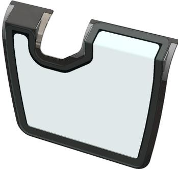
Hammerglass-Scheibe IR Green in Stahlrahmen zum Tausch gegen Originalscheibe. Mit werksseitig montierter ScreenSaver Schutzfolie. Hammerglass IR absorbiert die IR-Strahlung der Sonne und verringert die Erwärmung um 50%. Wird verklebt wie Originalscheibe. **ACHTUNG!** Verwenden Sie einen elastischen Kleber. NICHT den Standard Glaskleber verwenden. Folie kann ersetzt werden bei Kratzer, oder Beschädigungen.
