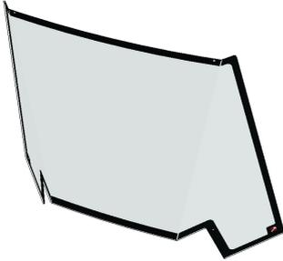
Hammerglass-Scheibe zum Tausch gegen Originalscheibe. Mit werksseitig montierter ScreenSaver Schutzfolie. Wird verklebt wie Originalscheibe. ACHTUNG! Verwenden Sie einen elastischen Kleber. NICHT den Standard Glaskleber verwenden. Folie kann ersetzt werden bei Kratzer, oder Beschädigungen.
