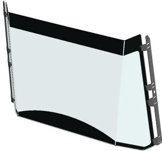
Hammerglass-Scheibe zum Tausch gegen Originalscheibe. Mit werksseitig montierter ScreenSaver Schutzfolie. Wird verklebt wie Originalscheibe. ACHTUNG! Verwenden Sie einen elastischen Kleber. NICHT den Standard Glaskleber verwenden. Folie kann ersetzt werden bei Kratzer, oder Beschädigungen.
