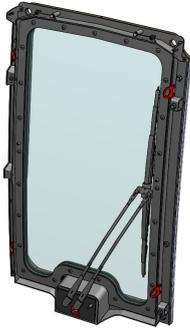
Hammerglass RABS Set. Beinhaltet: 12 mm RABS Frontscheibe in Stahlrahmen, 4 mm ScreenSaver Schutzscheibe, Klemmrahmen für ScreenSaver Schutzscheibe, Scheibenwischer. Explosionsgeprüfte Lösung. Die patentierte ScreenSaver-Scheibe schützt die stärkere 12 mm-Scheibe im RABS-Rahmen und ist ein Verbrauchsmaterial, die wenn sie verschlissen ist ausgewechselt werden.
