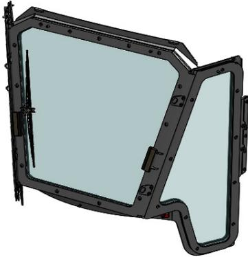
Hammerglass RABS Set. Beinhaltet: 12 mm RABS Frontscheibe in Stahlrahmen, 4 mm ScreenSaver Schutzscheibe, Klemmrahmen für ScreenSaver Schutzscheibe. Explosionsgeprüfte Lösung. Die patentierte ScreenSaver-Scheibe schützt die stärkere 12 mm-Scheibe im RABS-Rahmen und ist ein Verbrauchsmaterial, die wenn sie verschlissen ist ausgewechselt werden.
