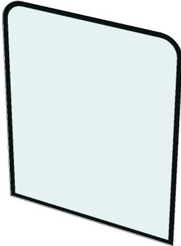
Hammerglass-Scheibe zum Tausch gegen Originalscheibe. Mit werksseitig montierter ScreenSaver Schutzfolie. Wird verklebt wie Originalscheibe. ACHTUNG! Verwenden Sie einen elastischen Kleber. NICHT den Standard Glaskleber verwenden. Folie kann ersetzt werden bei Kratzer, oder Beschädigungen.
