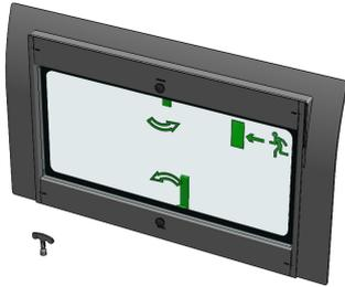
Hammerglass-Scheibe IR Green zum Tausch gegen Originalscheibe. Hammerglass IR absorbiert die IR-Strahlung der Sonne und verringert die Erwärmung um 50%. Wird verklebt wie Originalscheibe. **ACHTUNG!** Verwenden Sie einen elastischen Kleber. NICHT den Standard Glaskleber verwenden.
