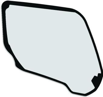
Hammerglass-Scheibe IR Green zum Tausch gegen Originalscheibe. Hammerglass IR absorbiert die IR-Strahlung der Sonne und verringert die Erwärmung um 50%. Wird verklebt wie Originalscheibe. **ACHTUNG!** Verwenden Sie einen elastischen Kleber. **NICHT** den Standard Glaskleber verwenden.
