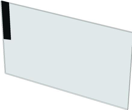
Hammerglass-Scheibe zum Tausch gegen Originalscheibe. Wird verklebt wie Originalscheibe. ACHTUNG! Verwenden Sie einen elastischen Kleber. NICHT den Standard Glaskleber verwenden.
